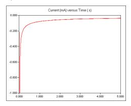
FIGURE 3.9: TYPICAL CHRONOAMPEROMETRY RESPONSE
